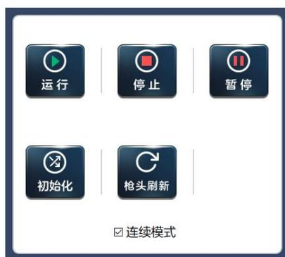
**运行**：顺序执行右边流程区内的所有子流程。
