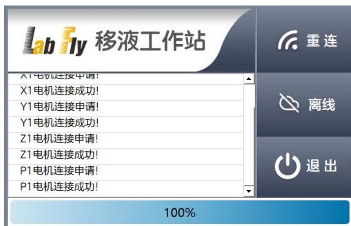
软件初始化完成后将在此界面连接设备，并把连接信息显示在信息框上。如无故障，连接成功后将自己跳转到软件主页；但如有故障将会停留此界面，并把对应的故障信息在信息框上显示；待故障排除后，可以点击【重连】或者点击【退出】后重新启动软件。同时，用户也可以在无法连接到设备时点击【离线】，进入离线状态，离线状态下，用户可以操作软件的大部分功能，运动功能除外。
