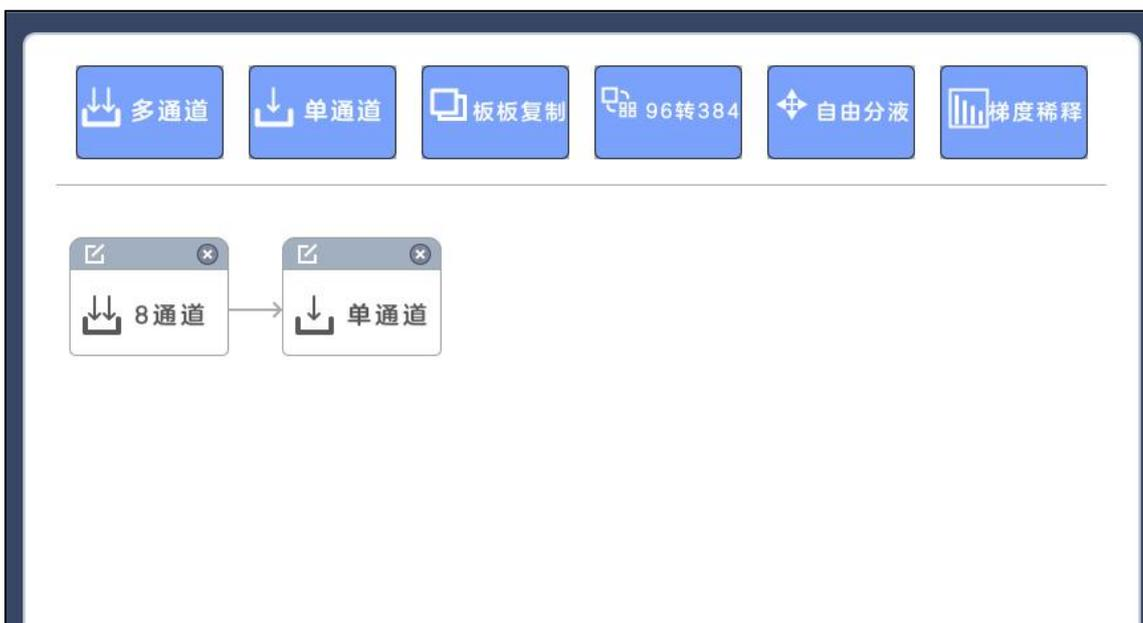
流程区：共分为以下几种流程块，8通道分液、单通道分液、板板复制、96PCR转384PCR、自由移液、梯度稀释，左键点击按住，将对应流程块拖拉到下方的流程区。
