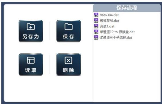
**另存为**：将当前流程及盘位另存为一个新流程并保存到"流程库"内，点击该按键后将弹出一个名称编辑框，用户输入新流程的名字后点击确定，保存成功后将在流程库里看到。
